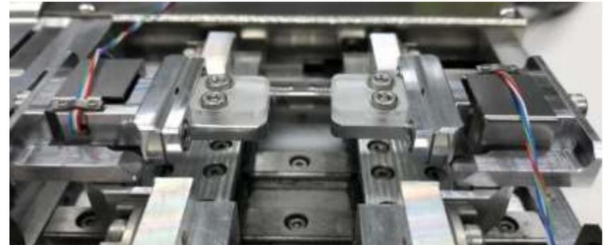
【 ロードセル部：拡大画像（抑えプレート取り外し：右側） 】
