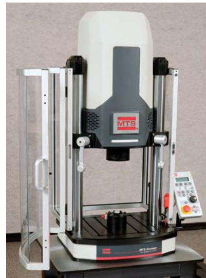
安全性を高めるオプションの試験エリア筐体を取り付けた MTS Acumen 試験システム
