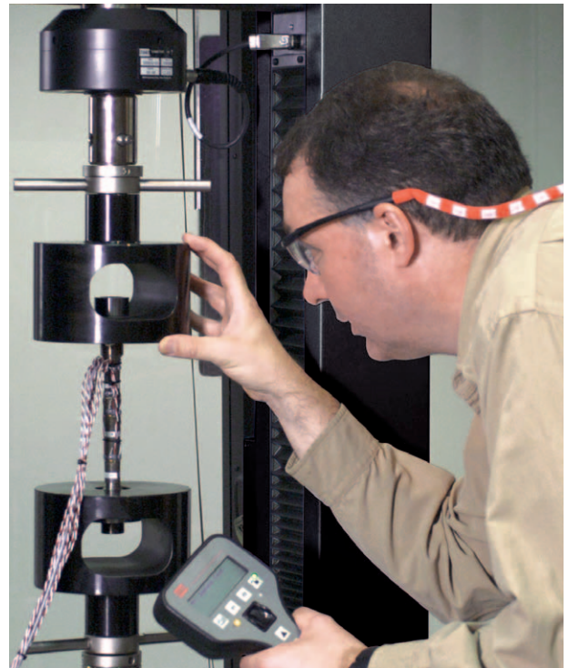
ロードフレームアライメント
