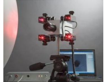
初期設定不要で、すぐ使えるこの光学システムは、非接触、全域対応で、繊維強化プラスチック、薄板、ハニカム、フォーム、木材、金属、グレアなどの材料の検査が可能です。検査時間は、通常10秒から30秒で、一回の検査で数ミリ平方から数メートルのエリアをカバーします。
