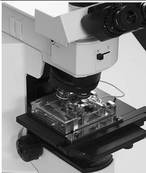
新開発の小型材料試験機（顕微鏡搭載イメージ）
